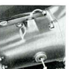
Wechselgetriebe- Öleinfüllschraube, Ölablaßschraube
