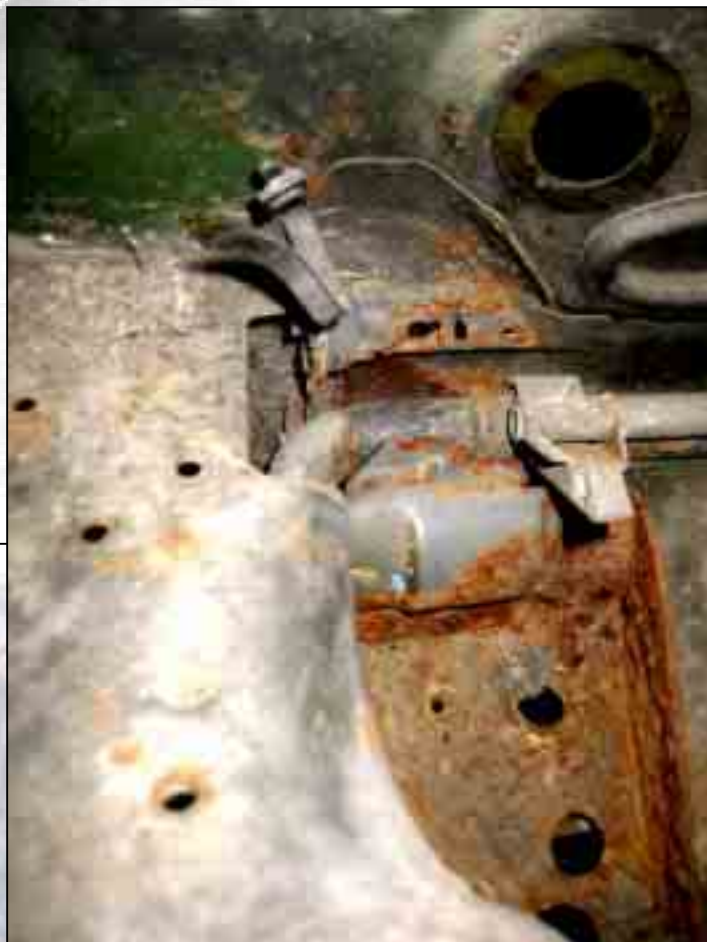
Bild oben: Totalverlust der Vorderachsaufhängung Bild unten: Kofferraumboden mit Unfallknick
