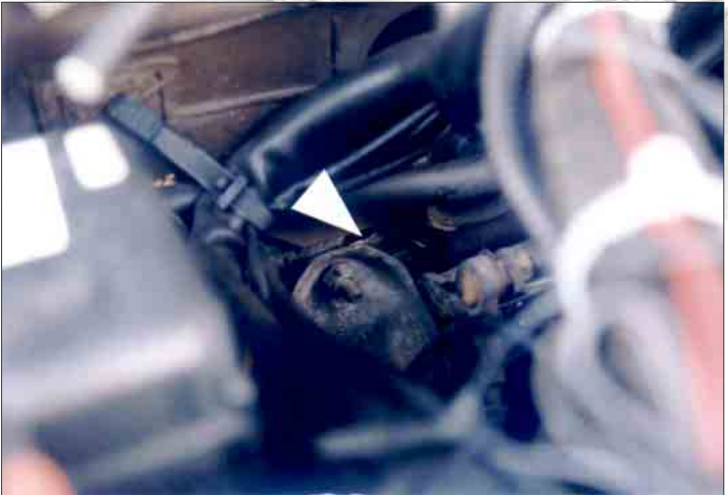
Bild unten: „Versteckter Riss der Vorderachsaufhängung“ (gleiches Auto wie Seite 5 oben, nur vor dem Zerlegen!)
