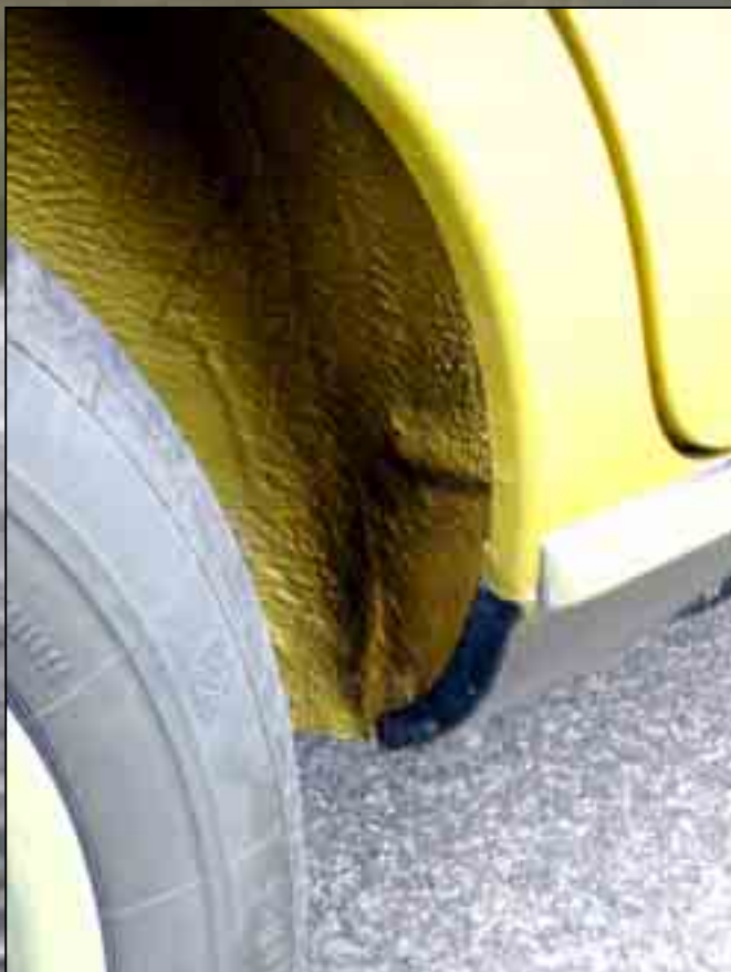
Bild oben: Meistens mehr Rost- als Wagenheberaufnahme Bild links: Beim 116 überlappt der Radlauf den mattschwarz lackierten Schweller
