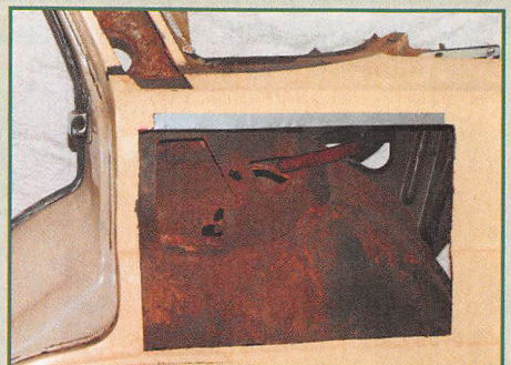
Hier im Schnitt, sonst nur zu ertasten: der tückische Bereich um die C-Säule
