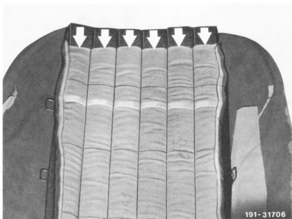
Bild 7 Befestigung der Heizstreifen in den Taschen der Gewebeunterlage
